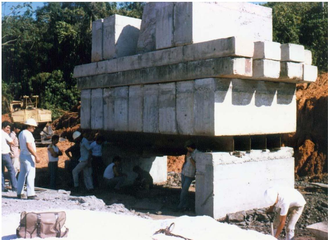
Pruebas de carga de los materiales de construcción, debajo de un puente de carga en el Embalse Superior, 1987.
